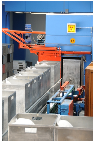
Contenedores ingresando a la cámara de irradiación
